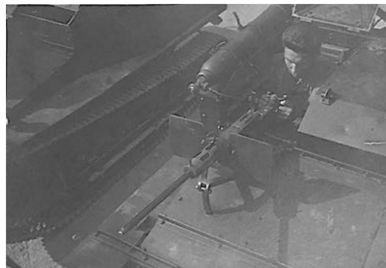
Figura 47 - Particolare della postazione del mitragliere di un CV 29
