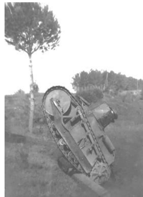
Figura 45 - Carro Fiat 3000 impegnato nel superamento di un ostacolo
