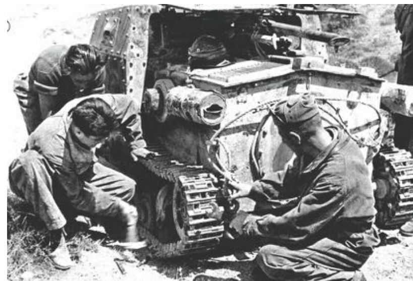
Figura 94 - Equipaggio di un carro leggero intento nella riparazione di un cingolo
