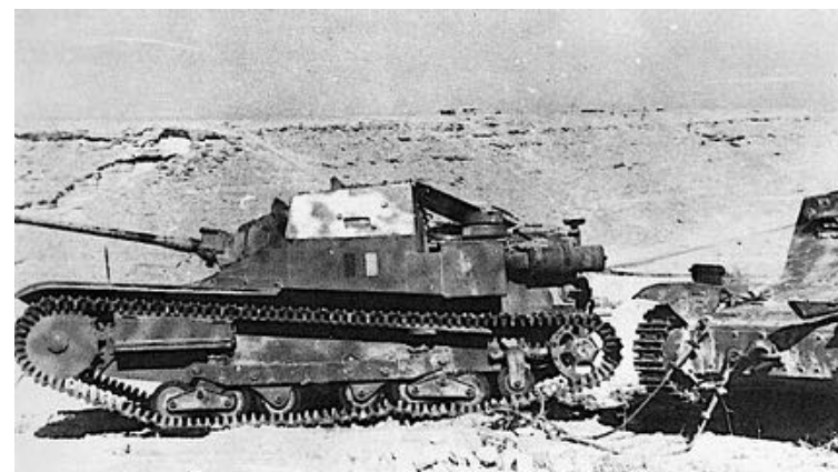
Figura 175 - Carro L 3 equipaggiato con fucilone anticarro in Libia
